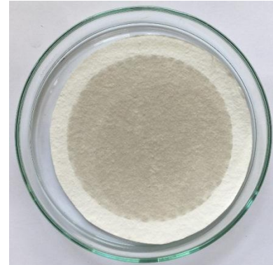
Filtr pyłowy z zanieczyszczeniami powstałymi w wyniku spalania ekogroszku w kotle spełniającym Ekodesign
